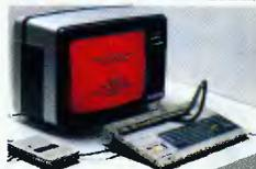
Si le microdidact utilise le crayon optique, appuyez sur la touche
