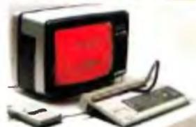
Si le microdidact utilise le crayon optique, appuyez sur la touche
